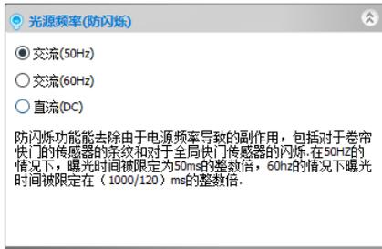
1. CMOS 探测器以序列的方式捕获每一行的像素(自上而下), 这种捕获方式存在**卷帘效应**, 所以也称之为**"卷帘快门"**。欧洲电源主频为**50Hz**, 光源在 1 秒内会闪烁 50x20 次, 在北美, 电源主频为**60Hz**, 光源在 1 秒内会闪烁 60x2 次;
