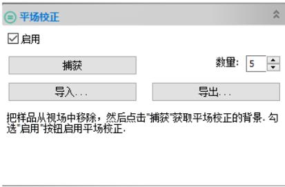
启用平场校正前，先从视场中移除样本或将样本移到空白区域并单击**捕获**按钮以获得用于**平场校正**的背景图像。捕获图像后，复选**启用**按钮即可**启用平场校正**。不复选**启用**按钮将禁用**平面场校正**；
