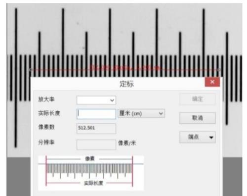
8. 读取与红色直线重叠部分显微标尺的**实际长度**，将数值填在**实际长度**选项中。当前**实际长度**为 450 $\mu\text{m}$ (每一小格为 10 $\mu\text{m}$ ,共 45 小格,)。**实际长度**数值也会在红色线的中间总像素数后显示。同时，软件计算显示其**分辨率**或**定标分辨率**。
